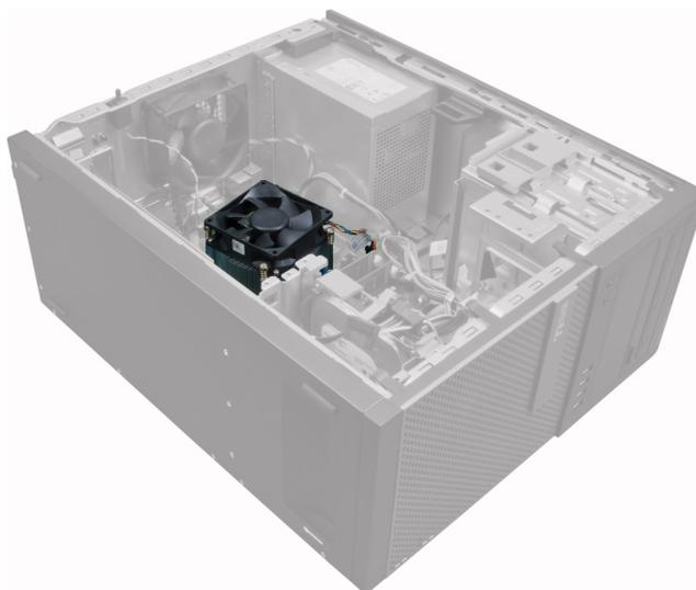
3. Tekan klip plastik untuk melepaskan dan memutuskan sambungan kabel heat-sink dari board sistem.
