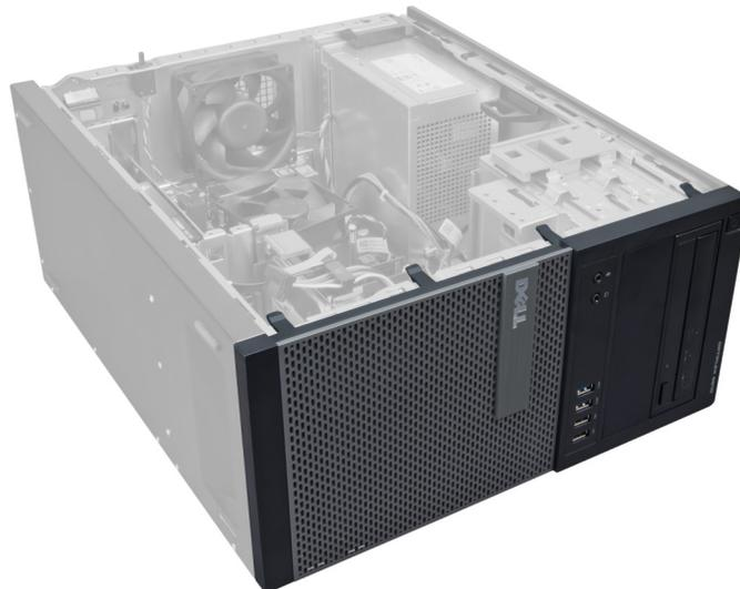
3. Cungkil secara perlahan klip penahan panel depan dari chassis yang terletak pada tepi panel depan.
