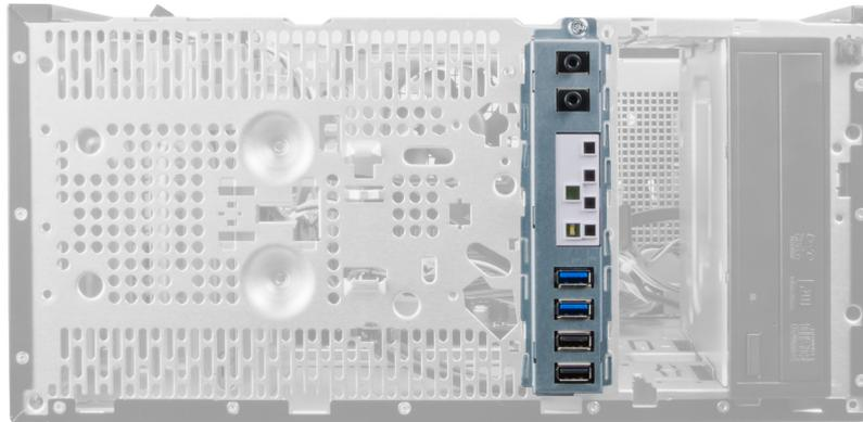
4. Lepaskan sambungan panel I/O atau kabel FlyWire dari board sistem.
